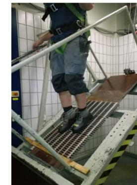
亚科盖板防滑等级测试依据德标DIN51130执行, 此规范中对食品工厂加工的不同区域的防滑要求作如下划分:
