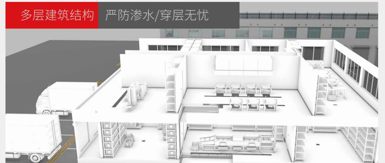
当中央厨房采用多层建筑结构，排水系统的出水口需要穿层时，对地漏的选择和铺设应极其谨慎，如处理不良，容易造成渗漏点。铺装完成投入使用后，一旦出现渗漏，修复极为困难，是中央厨房运营中挥之不去的痛。
