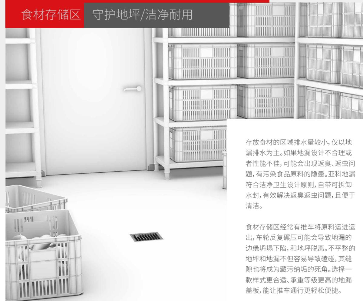
存放食材的区域排水量较小，仅以地漏排水为主。如果地漏设计不合理或者性能不佳，可能会出现返臭、返虫问题，有污染食品原料的隐患。亚科地漏符合洁净卫生设计原则，自带可拆卸水封，有效解决返臭返虫问题，且便于清洁。
